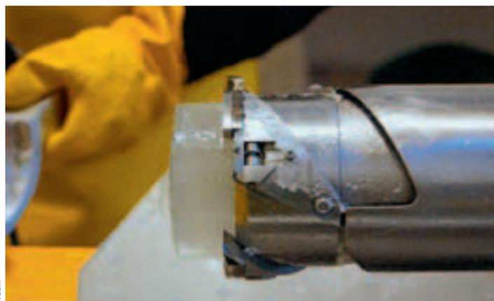
格陵兰岛冰核钻取。冰核是指垂直钻入冰原后获得的冰柱，用于重构过去125,000年内的大气条件。将冰核切成片段，对各片段中的冰进行分析。每个片段都反映了特定历史时期的大气条件。用于重构格陵兰冰原对过往气候变化反应的很多资料都是从冰核中获取的。
