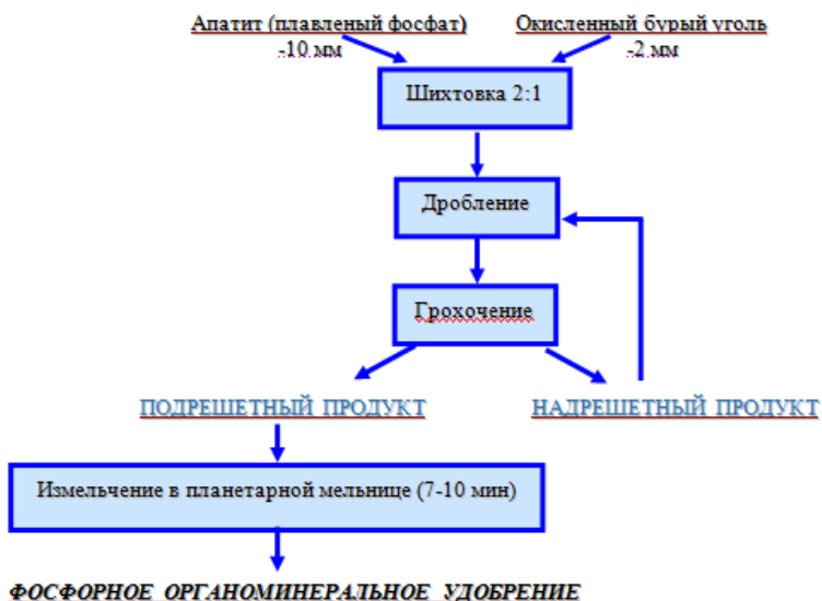
Рис. 3. Схема получения фосфорного органоминерального удобрения
