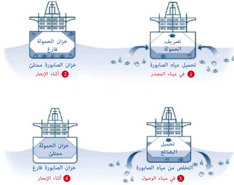
رسم توضيحي 1 مقطع عرضي لسفينة توضح موقع خزان الصابورة ودورة مياه الصابورة (المصدر: البرنامج العالمي لإدارة مياه الصابورة، المنظمة البحرية الدولية).
