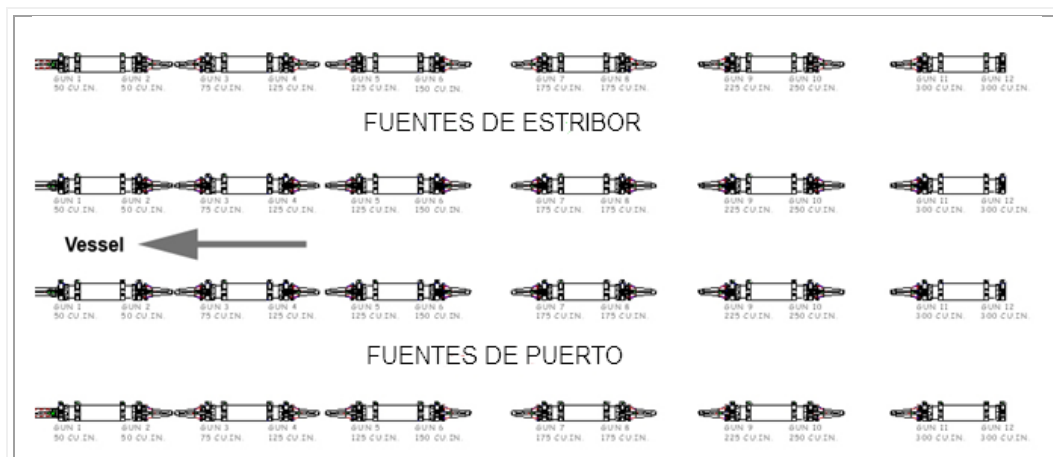
Figura N° D - 6 Configuración de las Cámaras de Aire Comprimido
