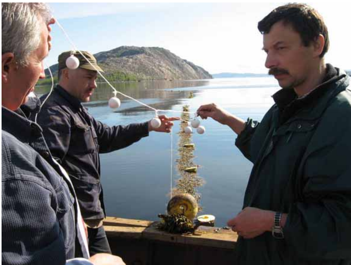
Рис. 10. Подготовка к проведению мониторинга за гидродинамикой методом гипсовых шаров
