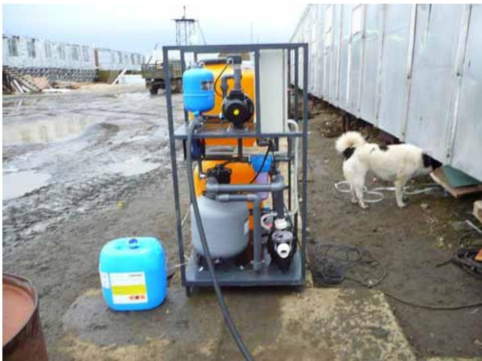
Рис. 6.3.4. Мойка и система водоочистки “KÄRCHER” в сборе
