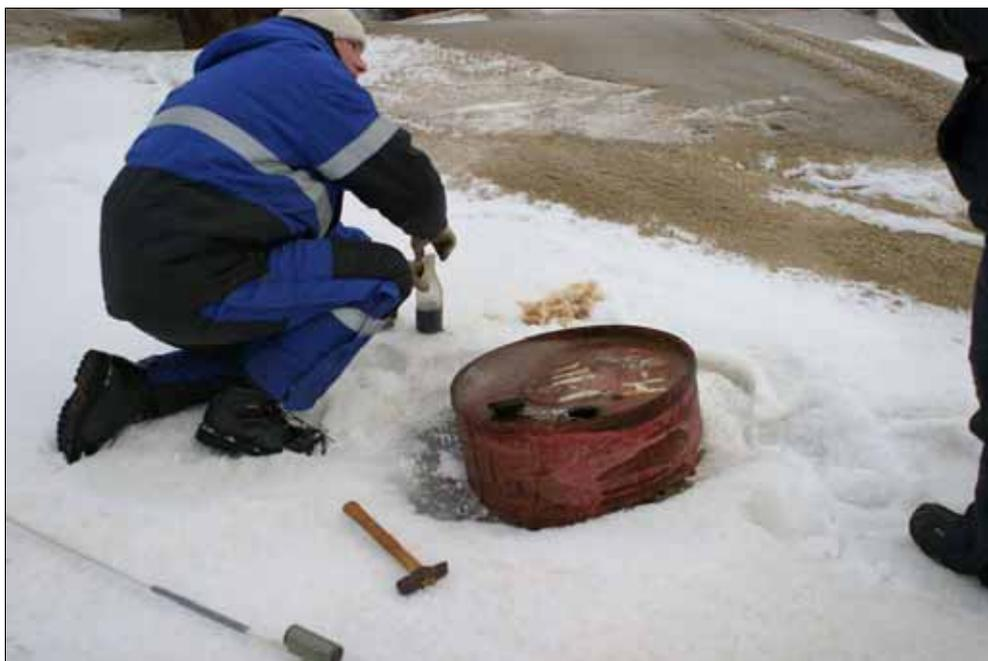
Рис. 5.5-5 Отбор образцов технических жидкостей на площадке 2 (авиагородок), о.Греэм-Белл
