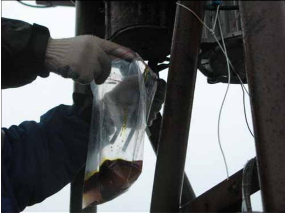
Рис. 5.5-1. Отбор образца технической жидкости из трансформатора локатора на площадке 9 (локаторная станция), о. Земля Александры
