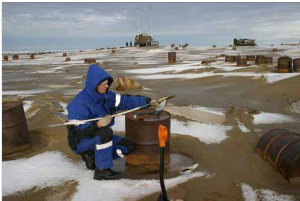
Рис. 5.5-6 Отбор образцов технических жидкостей на площадке 3 (ВПП), о.Греэм-Белл
