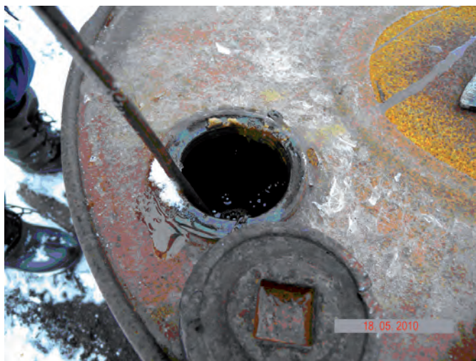
Рис. 25. Опробование бочки с моторными маслами на содержание ПХБ
