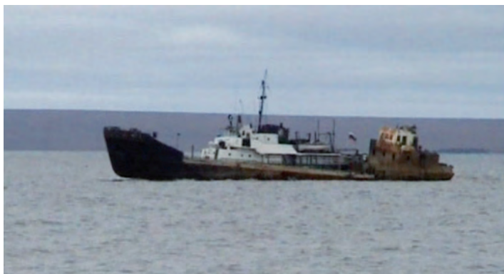
Рис. 28. Транспортировка поднятого на поверхность судна
