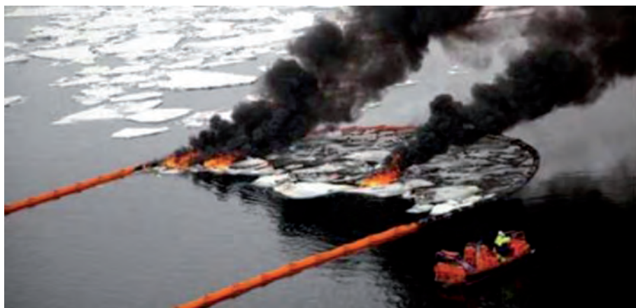
Рис. 52. Тестирование технологии сжигания
