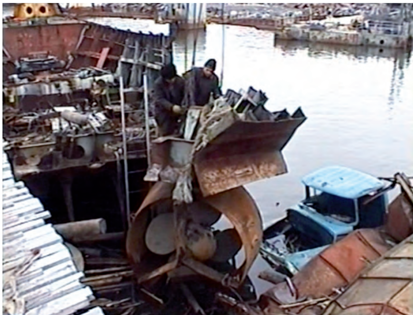
Рис. 29. Разделка и утилизация поднятого судна
