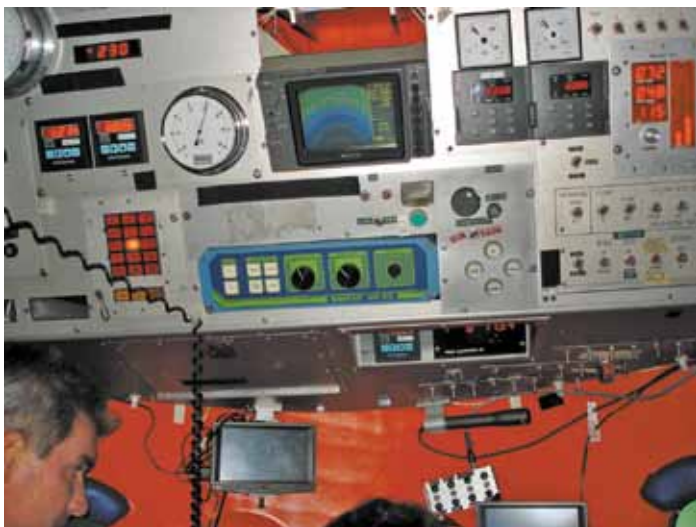
Рис. 3. Кабина ГОА «МИР» и бортовой компьютер
