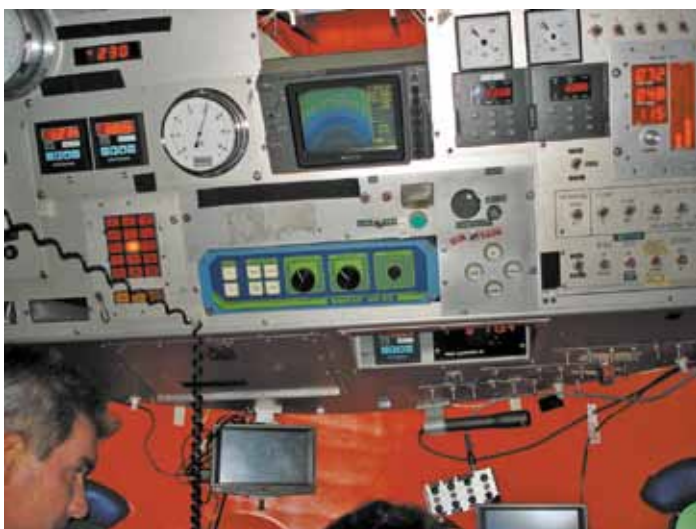
Рис. 3. Кабина ГОА «МИР» и бортовой компьютер
