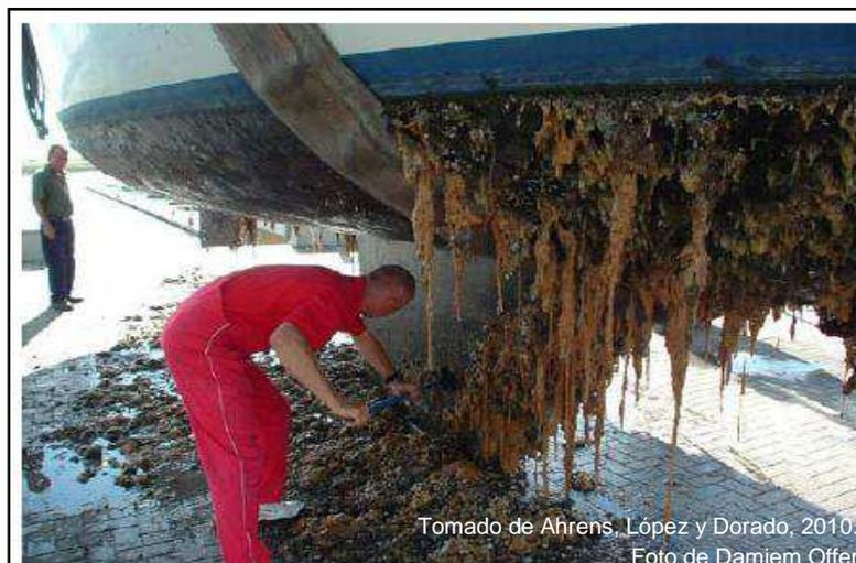
**Figura 2.** Limpieza de “Biofouling” incrustante en casco de barco.
