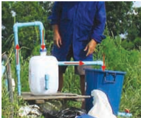
รูปที่ 6.1-12 การต่อท่อและทิศทางการไหลของกลิ่น
