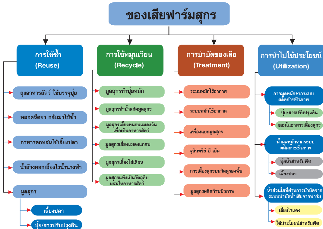
รูปที่ 3-2 แนวทางการจัดการของเสียจากฟาร์มสุกร
