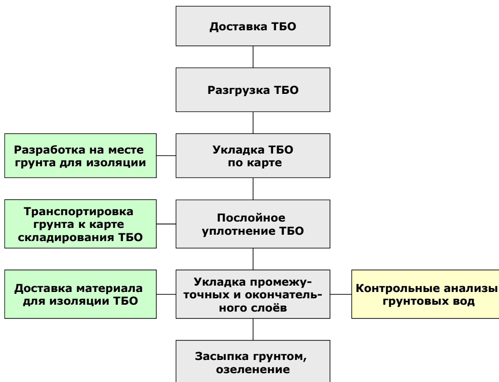
Рис. 5. Основные операции по эксплуатации полигона ТБО
